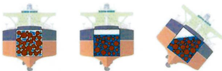
Figura 1 - Fenômeno de liquefação em carregamentos de minérios. Fonte: AMSA, 2018.
