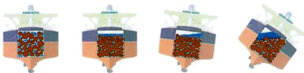
Figura 2 - Fenômeno da separação dinâmica em carregamentos de minérios. Fonte: AMSA, 2018.
